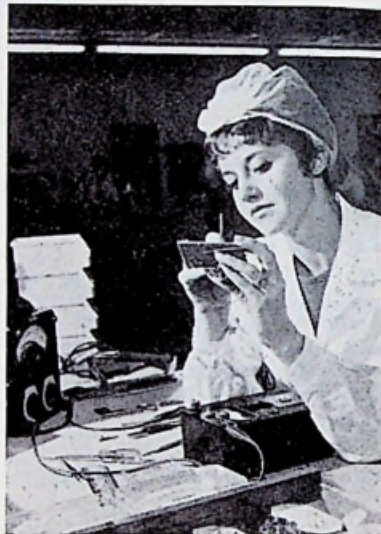
Afb. 2 - Het afstellen van het draaispoelsyst. van de nieuwe „model 15”
